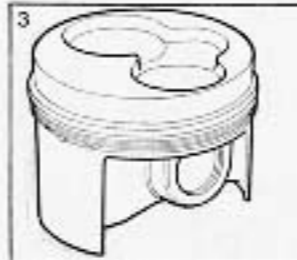
3) Πιστόνι από τον κινητήρα του 1965 SCA F2 της Κόσγουορθ. Φαίνεται το σχήμα κυκλικό σχήμα της έσοχής.
